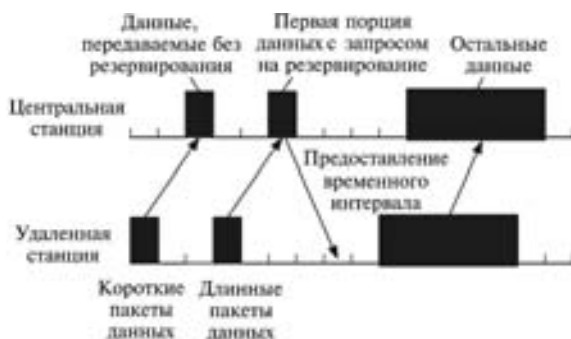
Рис. 5.8. Передача в режиме резервирования
