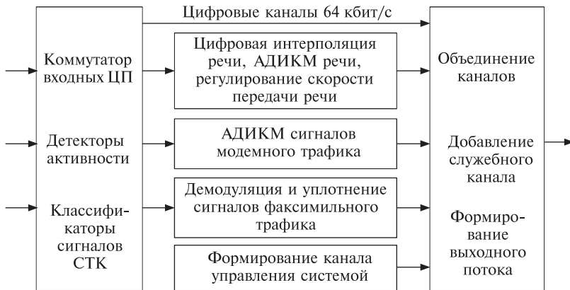
Рис. 7.9. Обобщенная схема формирования потока в оборудовании ЦИР-АДИКМ
